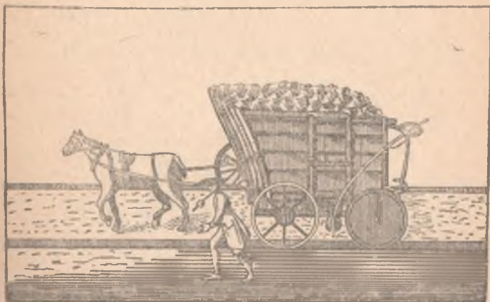
Конная рельсовая дорога с деревянными рельсами, применявшаяся для перевозки угля в Англии в XVII—XVIII веках
