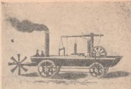
Паровая землечерпалка американского изобретателя Оливера Эванса, могущая передвигаться по суше и по воде (1801 г.)
