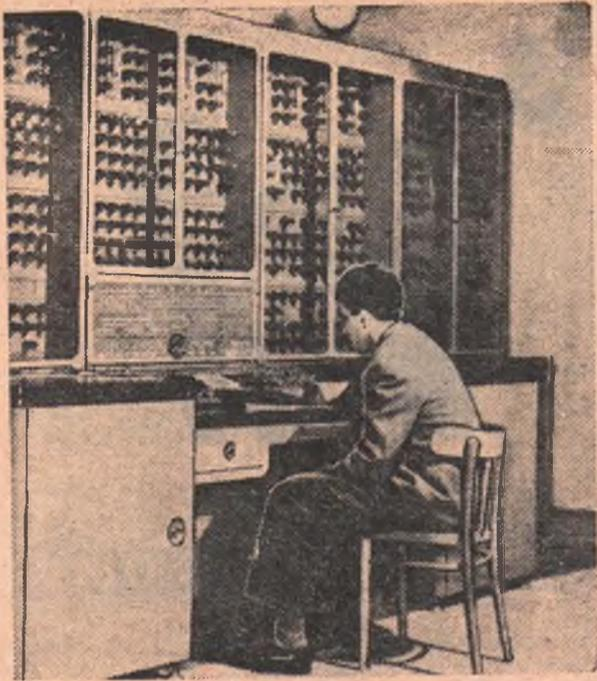
Чехословацкая Республика. Институт теории информации и автоматизации Чехословацкой академии наук получил из Советского Союза электронную автоматическую счетную машину «Урал». Сейчас заначивается сборка машины и начаты испытания. На снимке: машина «Урал», установленная в институте.
